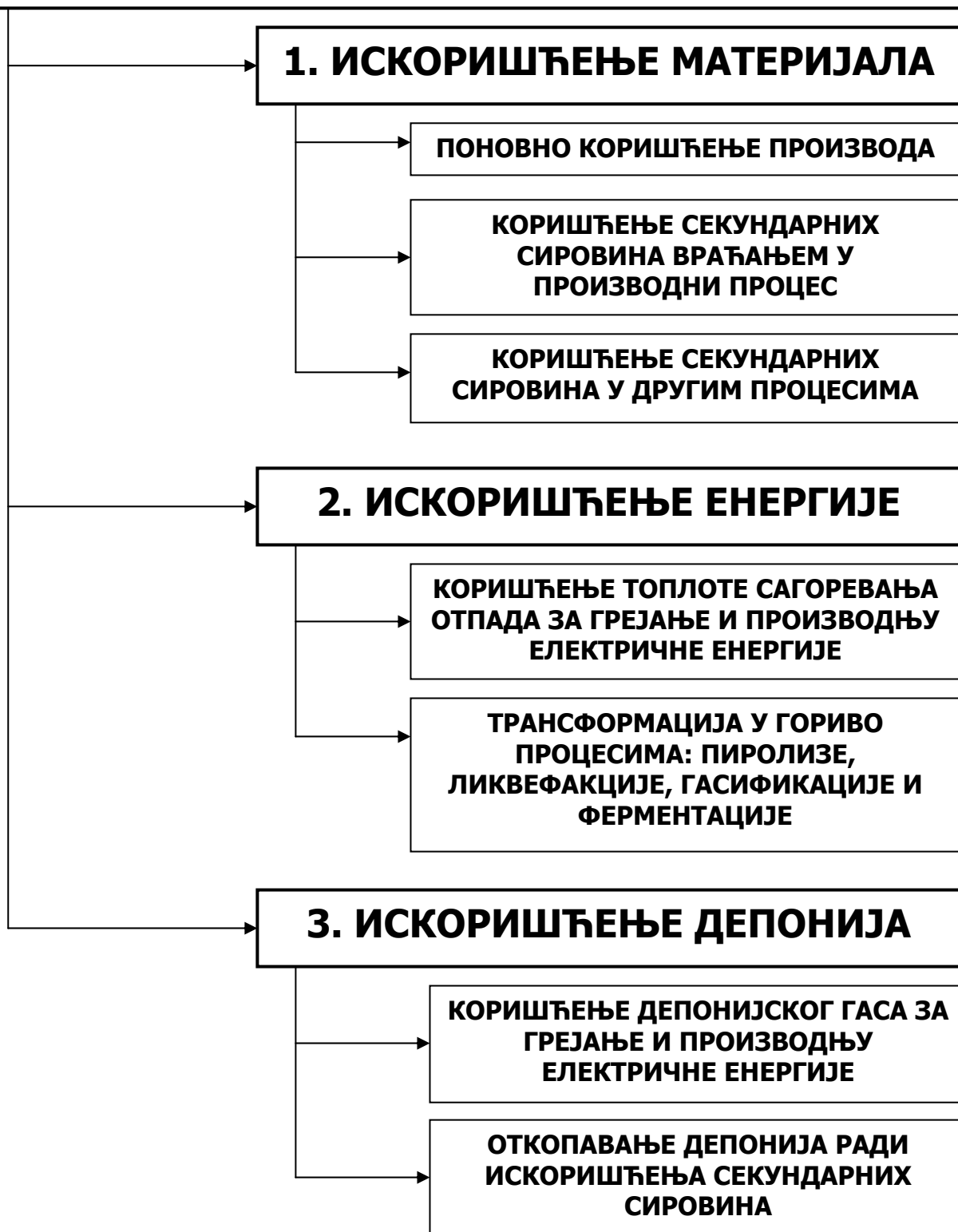
Слика 4 - Могућности прераде отпада уз искоришћење енергије и сировина
