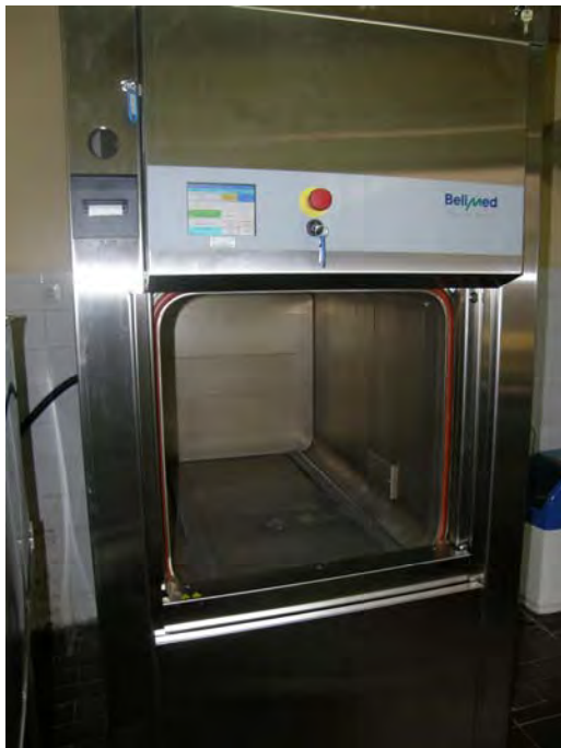
Слика 30 - Аутоклав за стерилизацију инфективног медицинског отпада
