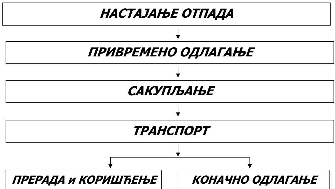
Слика 3 - Елементи интегралног система збрињавања отпада
