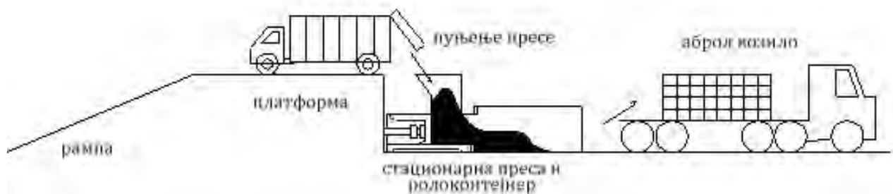
Слика 89 - Принцип рада трансфер станице
