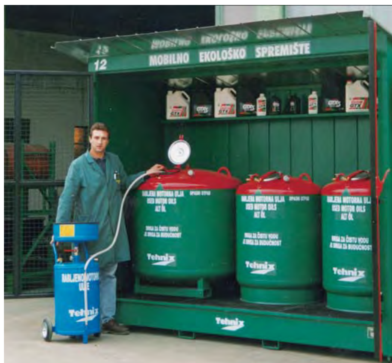
Слика 67 - Пример складишта за отпадна уља
