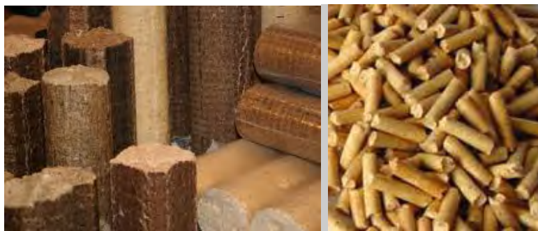
Слика 83 - Изглед брикета (лево) и пелета (десно) од пресоване биомасе
