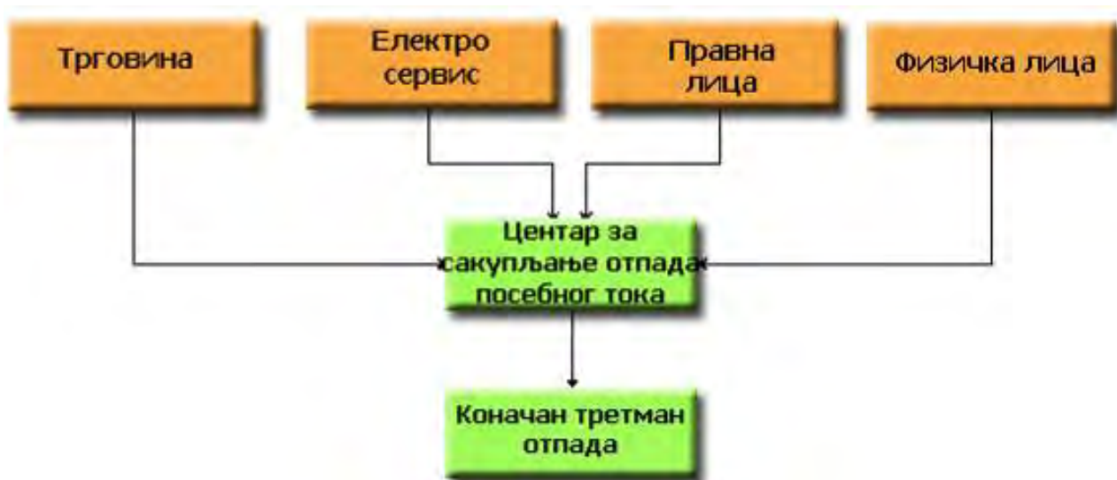
Слика 75 - Шема сакупљања отпада електронских-електричних производа
